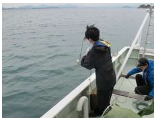
実験実習艇での海洋調査 「CTD による水温・塩分測定」
