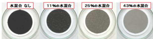
図2 燃料油と水の混合割合によるPM捕集フィルターの変化
