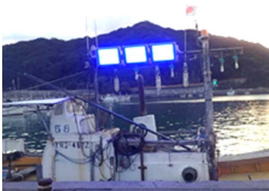
図1 漁船に搭載した試作省エネ型LED集魚灯
