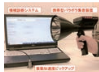
機械診断システム「Wave Diag」と携帯型振動・音響測定装置「SVスマレコ」
